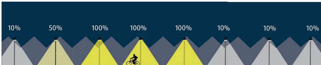
Abb. 64 Intelligentes Beleuchtungskonzept mit „mitfahrendem“ Lichtkegel, Masterplan für die Veloschnellroute Spoorbaanpad, Almere (NL) [35]
